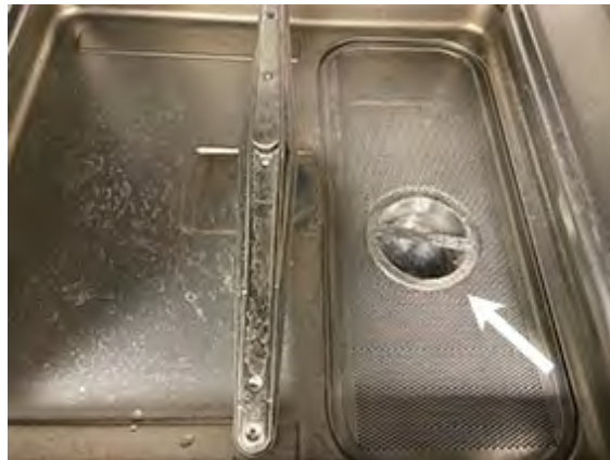
Abbildung 12 Filter bei optionaler Entleerungspumpe
