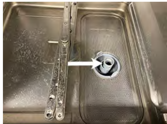
Abbildung 10 Das Überlaufrohr entfernen.
