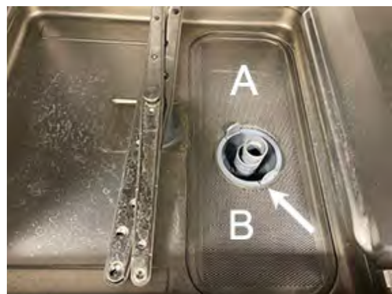
Abbildung 11 Herausnehmen von Tankgitter und Filter
