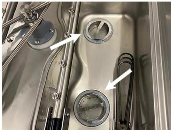
**Abbildung 25** Ausbau der Filter
