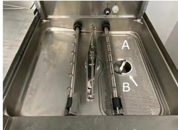
**Abbildung 22 Herausnehmen von Tankgitter und Filter**
