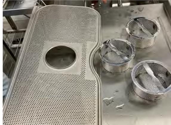
**Abbildung 26** *Reinigung der Filter und des Tankgitters*
