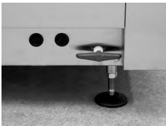
obraz 24 Dostęp do zabezpieczeń przed przegrzaniem
