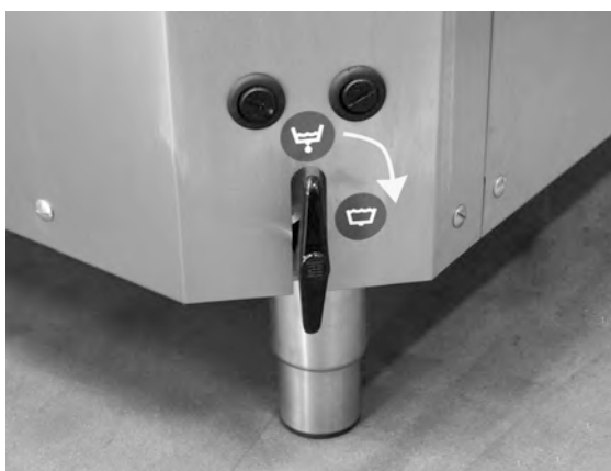
Photo 6 Vanne de remplissage
