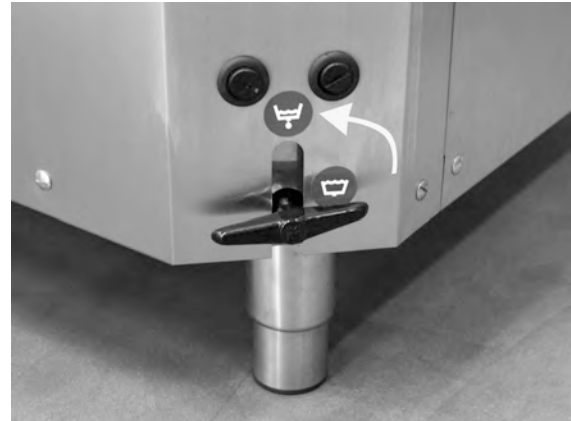
Photo 29 Vanne de remplissage
