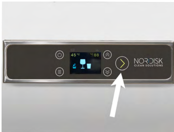
Bild 3 Påfyllning av vatten
