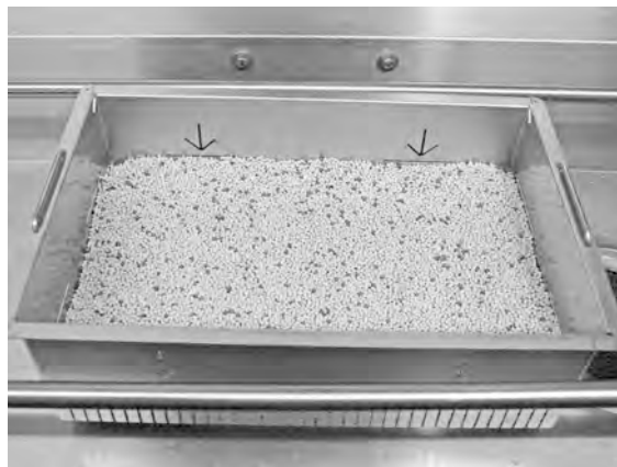
Fig. 22 Check Granule level
