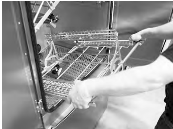
Fig. 6 Tilt the insert up
