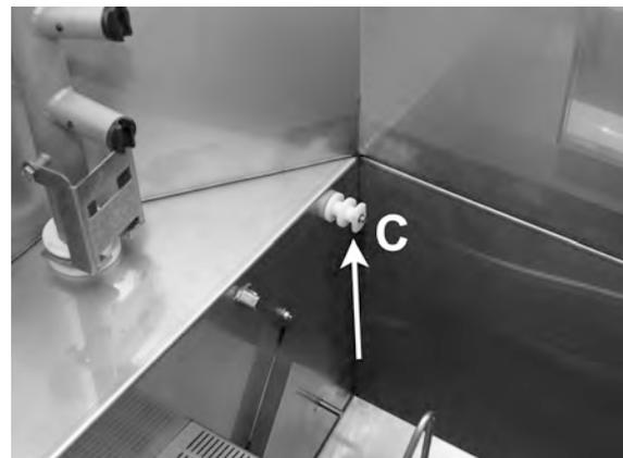
**Photo 26** *Capteur de niveau*
