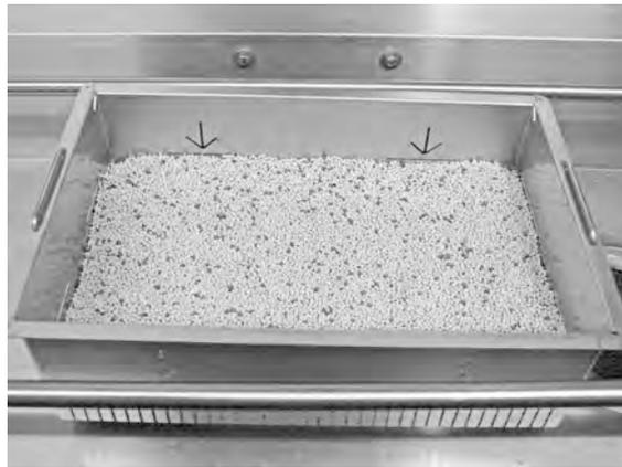
**Photo 21 Contrôlez le niveau de Granules**
