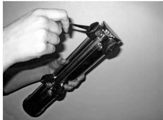
Imagen 24 Limpieza de las boquillas de lavado
