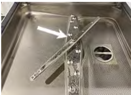
Imagine 14 Brațe de spălare inferioară și clătire
