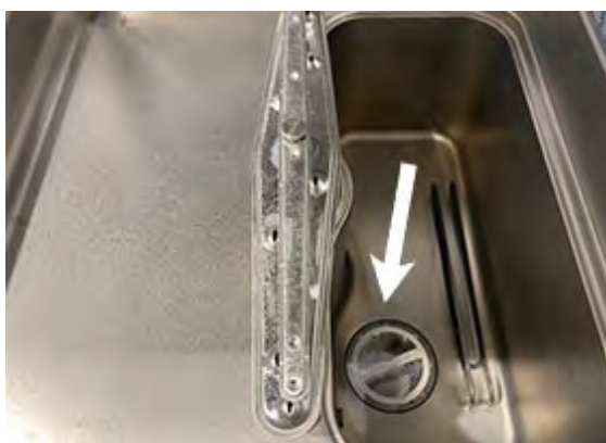
Imagine 13 Filtrați când opțiunea are pompă de scurgere
