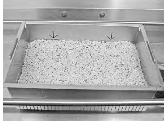
Photo 33 Contrôlez le niveau de Granules
