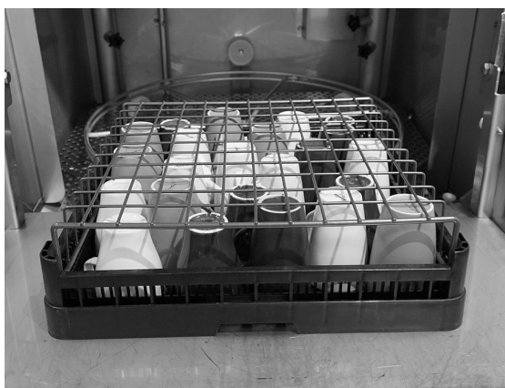
Photo 22 Grille de protection
