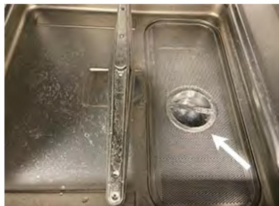
**Imagen 12 Filtrar para opciones con bomba de desagüe**
