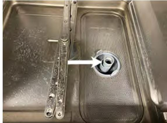
**Imagen 10 Retirar el tubo de desagüe**
