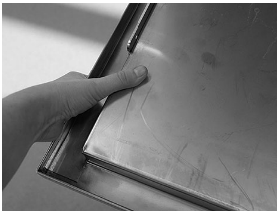
Figura 27 Tenere una mano sotto il portello
