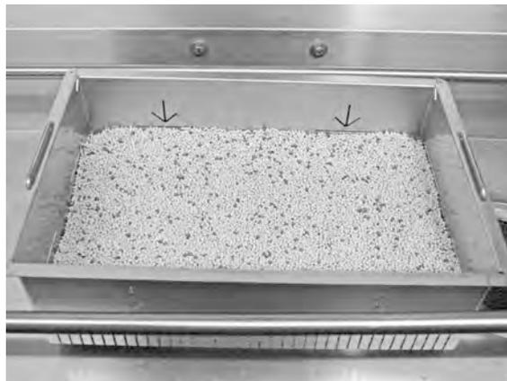
**Figura 25 Controllare il livello dei granuli**
