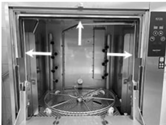
Fig. 33 Door frame to clean
