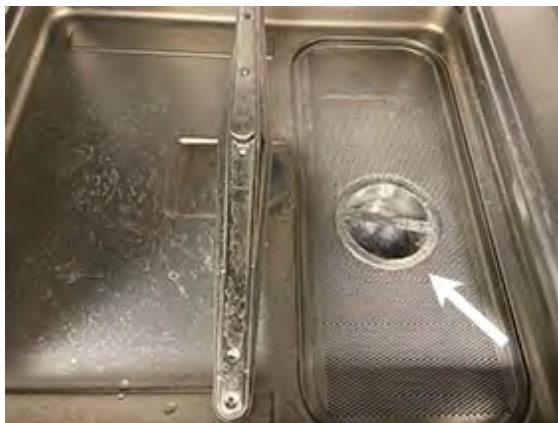
Imagine 12 Filtrați când opțiunea are pompă de scurgere
