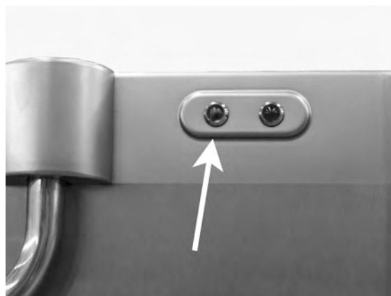
Billede 18 Når programmet er færdigt, tænder den grønne lampe.
