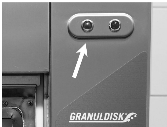
Photo 21 Lorsque le programme est terminé, le témoin vert s'allume.
