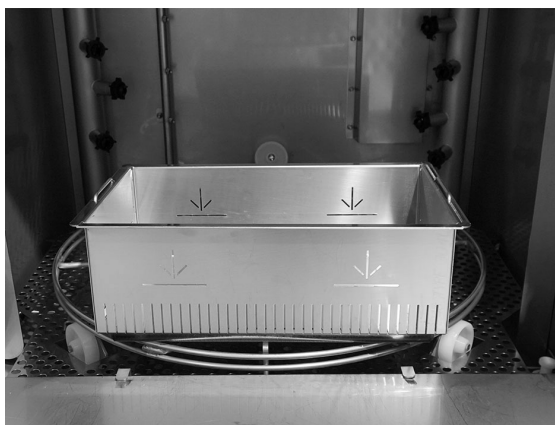
Photo 30 Collecteur de Granules dans le Lave Batterie
