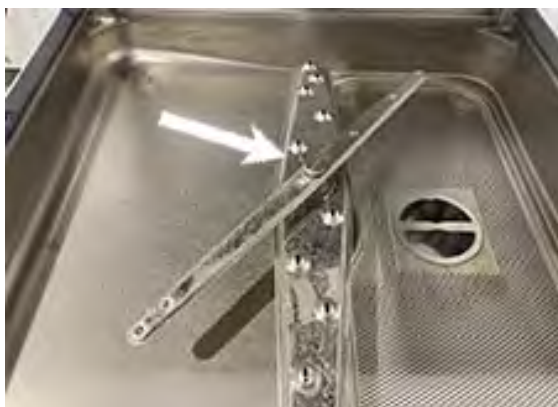
Obrázek 14 Dolní mycí a oplachovací ramena
